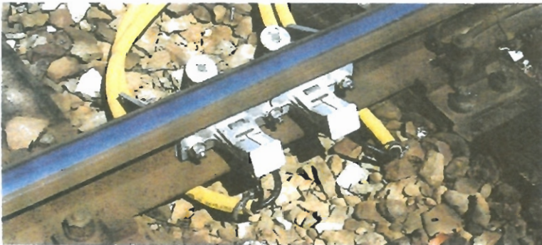
De assenteller, een speciale vorm van treindetectie.
