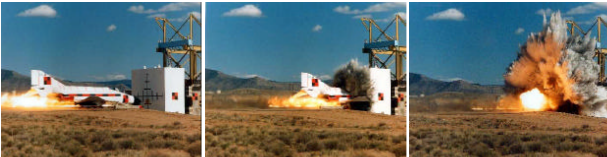
Figuur 7 - 8 - 9, crashtest F-4 Phantom op rails
