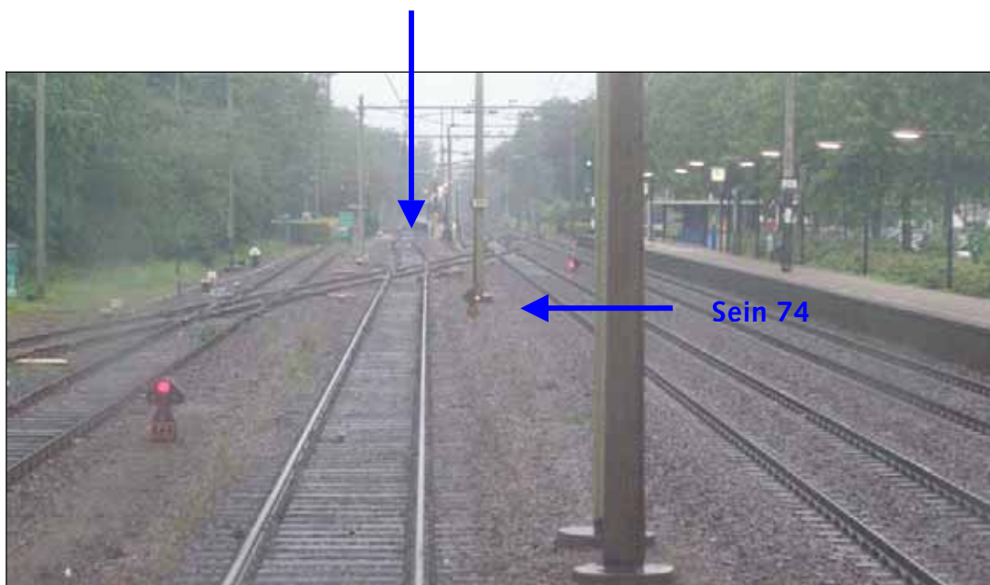
Afbeelding 7: Sein 74 toont het seinbeeld geel-knipper voor een rijweg naar spoor 923 (zie pijl).
