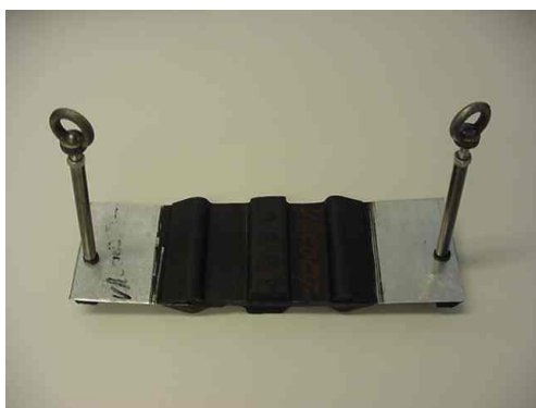
Fig 12.5-6 Het W9Ui profiel met stalen injectiepenen gemonteerd. De pen met oog is een draadstang die door een mantelbuis loopt en vast zit gedraaid aan het vormgevormde schoentje over het sponsinjectie rubberstrookje.
