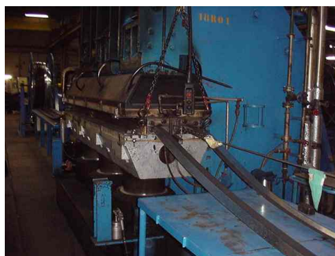
Fig 12.4 Het vulkaniseren (matrijs) W9Ui profiel
