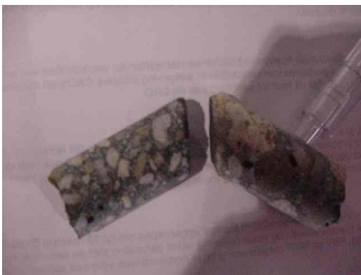
Fig 10.11.9 Na contact retourwater injecteren met MC GL95TX
