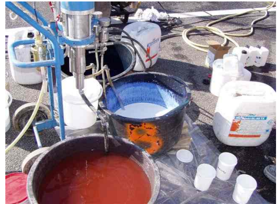
Fig 11.8 Injectiematerieel 2 componentenpomp Wit is de latex component
