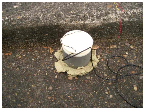
Fig 10.14.16 Sensoren op het asfalt met apparatuur Fig 10.14.17 Detail sensor op bentoniet op nat asfalt
