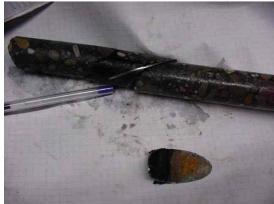
Fig 10.6.4 De dilatatievoeg is aangeboord en stroomt het water uit het gat en uit de voeg boven het rubberprofiel. De beton boorkernen worden gecontroleerd.
