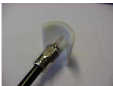
Fig 12.12 Voorontwerp van een kunststofvoetje met daarop een rond HD injectieslang. Dit bleek niet robuust genoeg voor montage op het rubber sponsprofiel.
