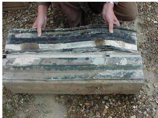
Fig 12.7 Proefstort met een W9Uj, lucht onder rubber Fig 12.8 Opengemaakte balk controle luchtbellens en injectiehars
