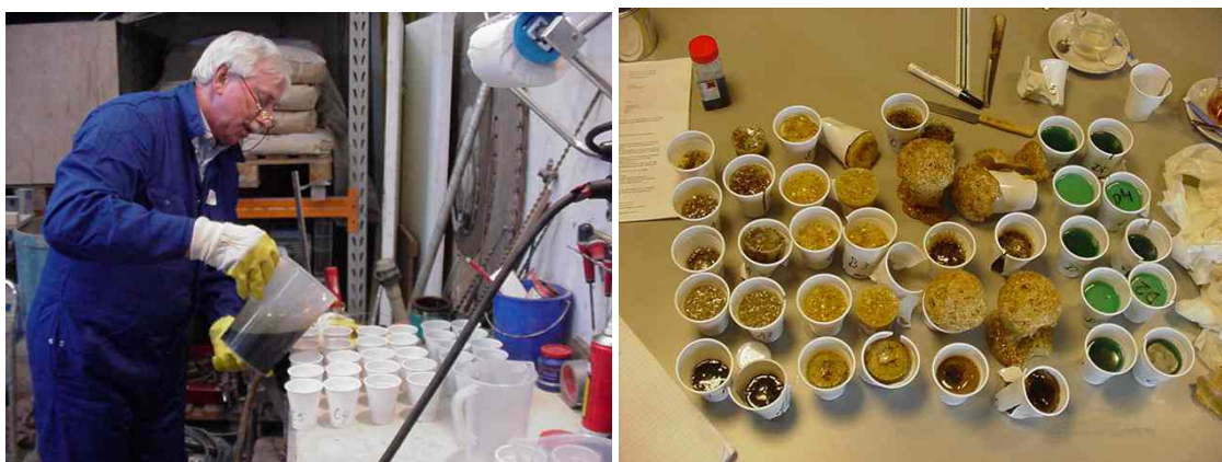
Fig 11.2-11.3 Proefbekertjes met diverse polyurethanen (bruin) en Polymert 150 (groen) met water geroerd.
