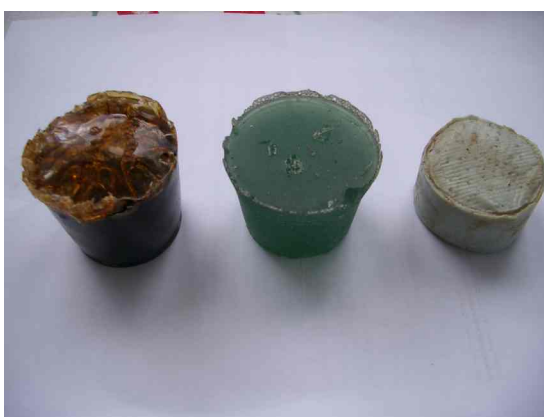
Fig 10.11.14 v.l.n.r.: polyurethaan, Polymert 150 mpas, MC GL 95TX
