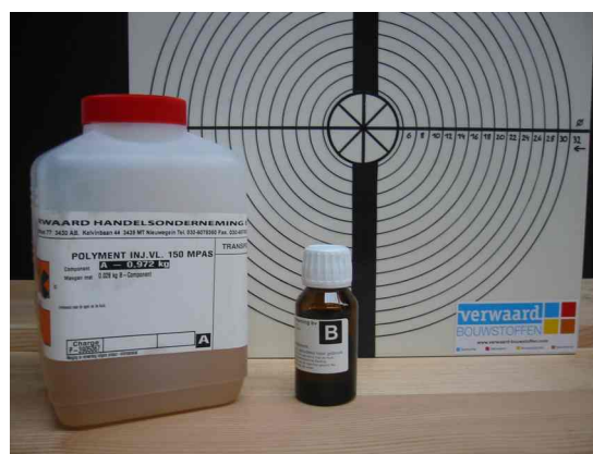
Fig.10.11.15 Polymert 150 mpas, A en de B component in bruin flesje
