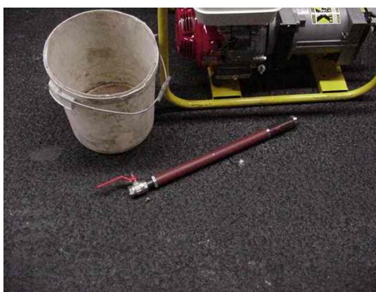
Fig 10.5.7 Afsluitbare packer voor boorgat 40 mm
