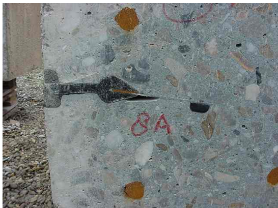
Fig 12.7 Proefstort met een W9Uj, lucht onder rubber Fig 12.8 Opengemaakte balk controle luchtbellens en injectiehars
