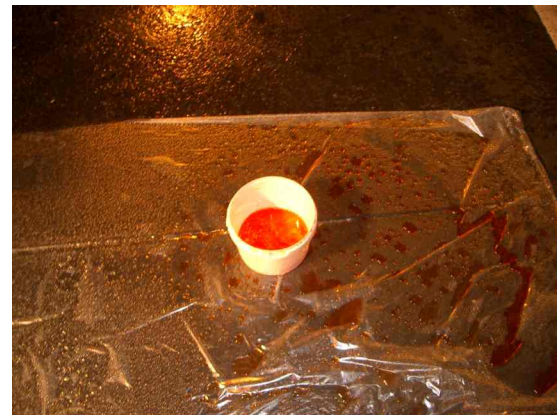
Fig 10.10.6 Injecteren water met kleurstof. Eerst een licht rose verkleuring. Fig 10.10.7 Daarna een donkerder rode kleur. Er is verbinding met de lekweg door de dilatatievoeg. Bepalen uitstroomtijd gekleurd water voor de bepaling van de zoutdosering injectievloeistof MC.
