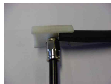
Fig 12.12 Voorontwerp van een kunststofvoetje met daarop een rond HD injectieslang. Dit bleek niet robuust genoeg voor montage op het rubber sponsprofiel.
