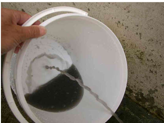
Fig 10.15.5 Zand stroomt mee uit dilatatievoeg
