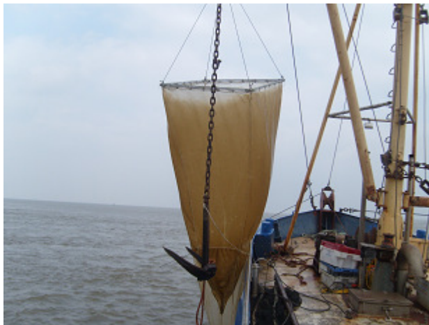
Figuur 2.6 Groot larvennet voor bemonstering onttrekkingsgebied Eems (met anker).
