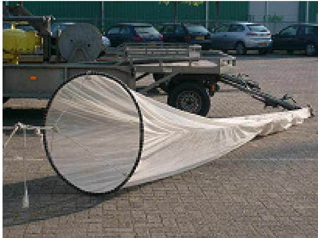
Figuur 2.4 larvennet E.ON-centrale en Shell Moerdijk
