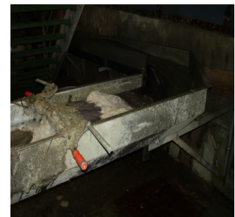
Net voor opvangen van het speelwater (debris) van de zeven van de EC20 eenheid
