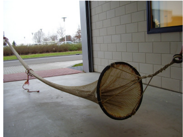
Figuur 2.5 larvennet inlaatkanaal Eemscentrale
