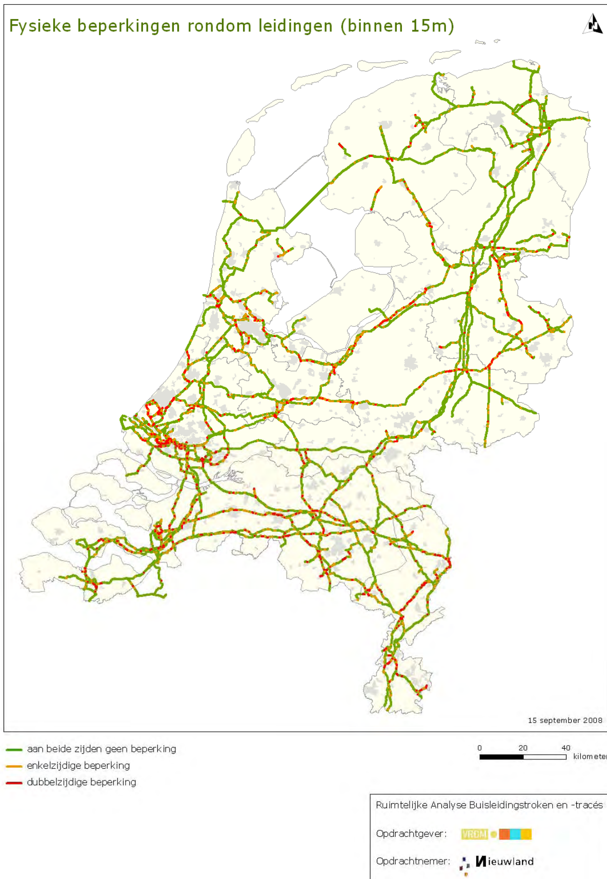
Kaart 7 – Overzicht buisleidingsegmenten met fysieke beperkingen aanwezig binnen 15 meter rondom de buisleidingen
