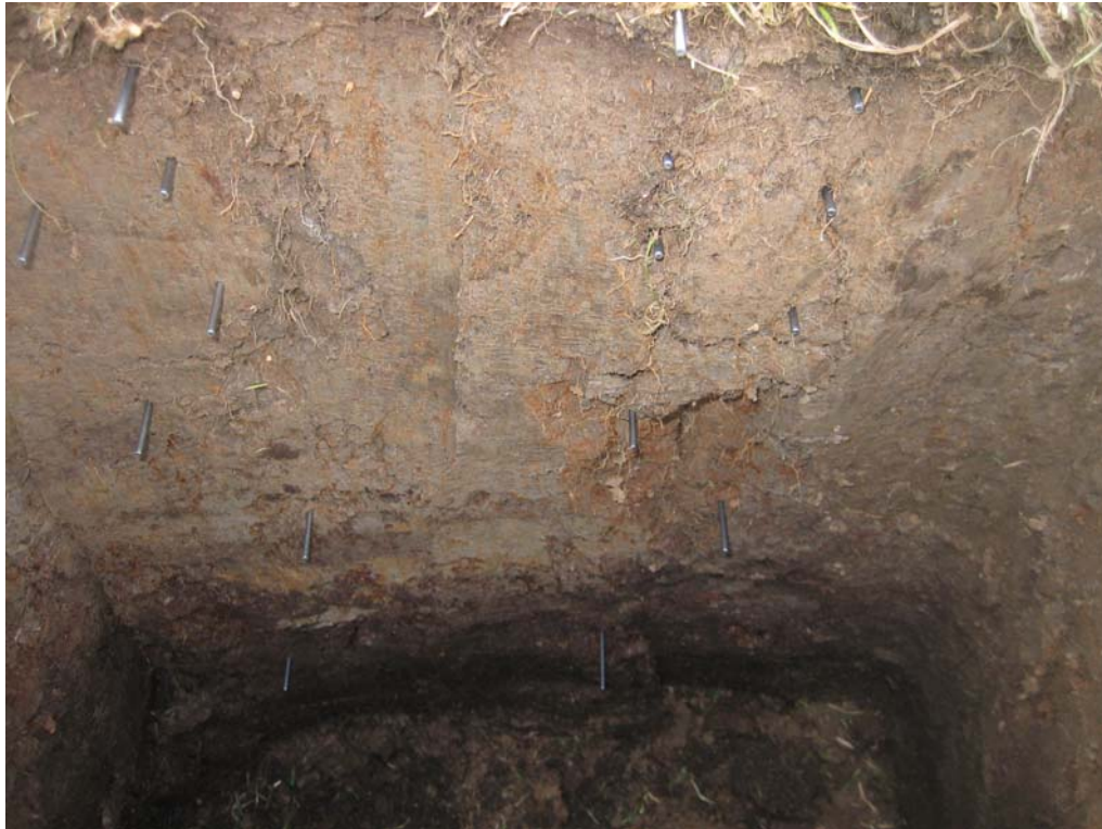
Figuur 4 Nadat de mal verwijderd is kunnen de pinnen één voor één worden vervangen door de sensoren.
