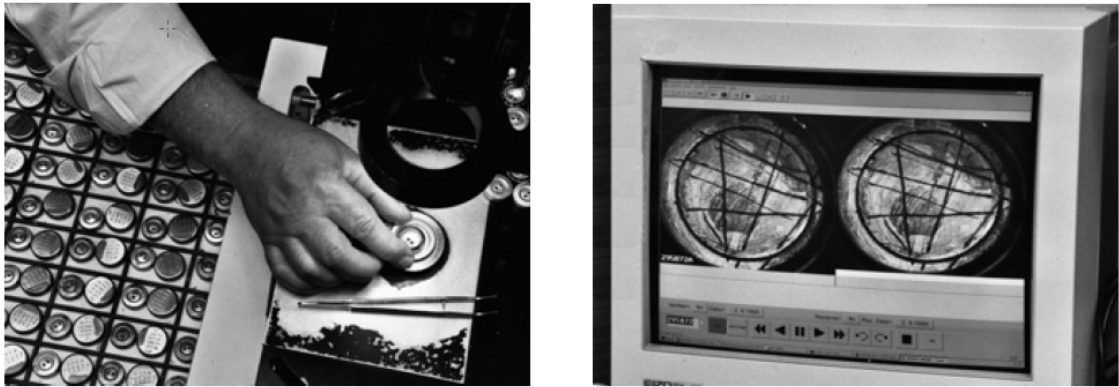
Figuur 7 Controle van zogenoemde ‘safeguard seals’ door een inspecteur. (Foto IAEA)
