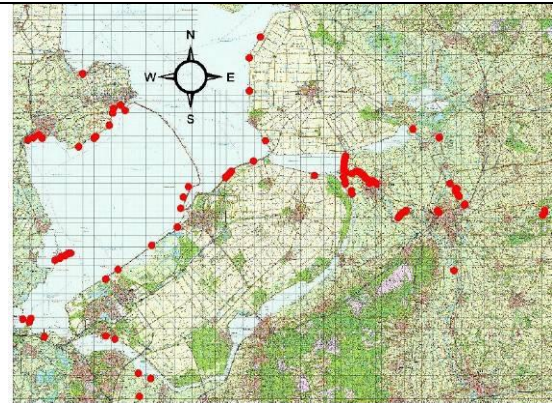
Figuur 9 : Locaties met dijkhoogte tekort voor de situatie in 2007. Voor het bepalen van het HBN is gerekend met een overslagdebiet van 1 l/s/m (Alkyon, 2007)
