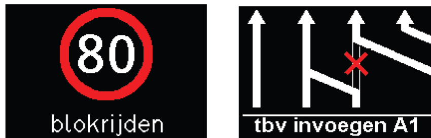
Figuur 8.3: Schematische weergave van twee voorbeelden waarbij een bermDRIP kan worden ingezet ten behoeve van het ondersteunen van verkeersmaatregelen
