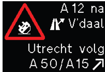
Figuur 8.4: Schematische weergave van een voorbeeld waarbij de weggebruiker via een pictogram op een bermDRIP wordt geïnformeerd over een ongeval
