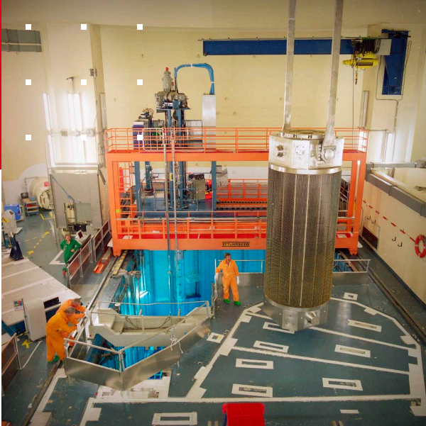
Hijsen van container voor afvoeren van gebruikte splijtstof-elementen
