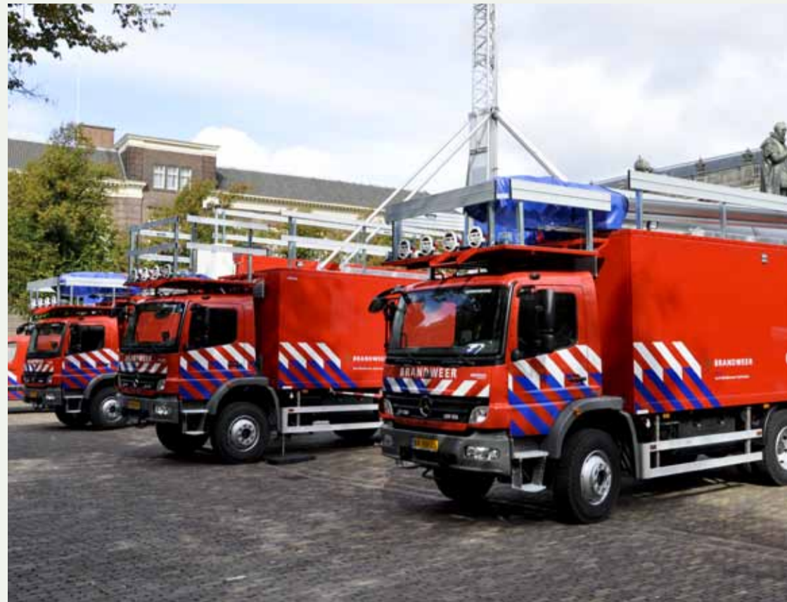
Op 24 september jl. stelde voormalig staatssecretaris Bijleveld drie nieuwe mobiele C2000 masten beschikbaar aan politie, brandweer en ambulancediensten. De nieuwe zendmasten werden aangeboden op het Plein in Den Haag. Het gaat om drie brandweerauto's met daarop uitschuifbare masten. De mobiele opstelpunten, waarvan er nu zes zijn, worden ingezet bij calamiteiten en evenementen om een optimale dekking te garanderen van het C2000 communicatiesysteem.
