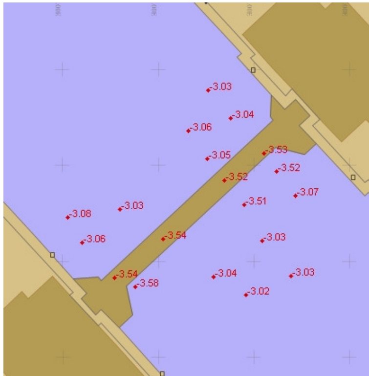
Figuur 17 : Sluis St. Andries (hefdeuren). Verder naar het zuiden al snel veel sediment op de bodem.
