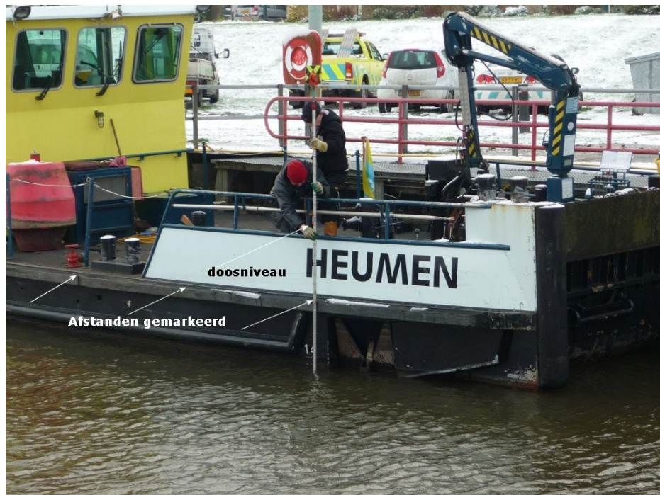
Figuur 6 : Er wordt gebruik gemaakt van een doosniveau, afstanden gemarkeerd aan boord.
