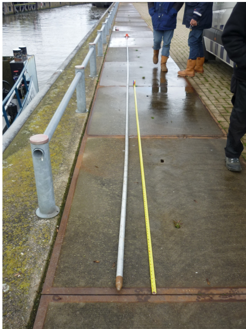
Figuur 5: De lengte van de prismastok wordt gemeten
