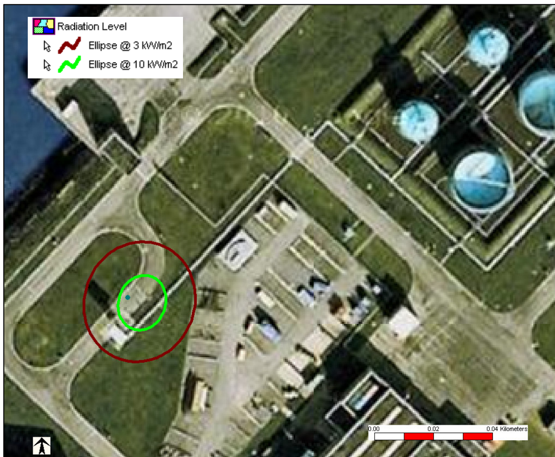
Figuur 6: Warmtestralingcontouren - putlekkage Pollendam tijdens boring/completion
