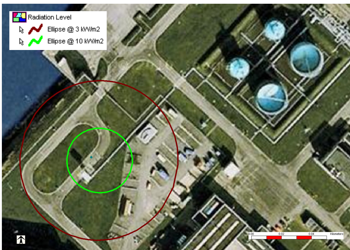
Figuur 5: Warmtestralingcontouren - Blow out Pollendam tijdens boring/completion
