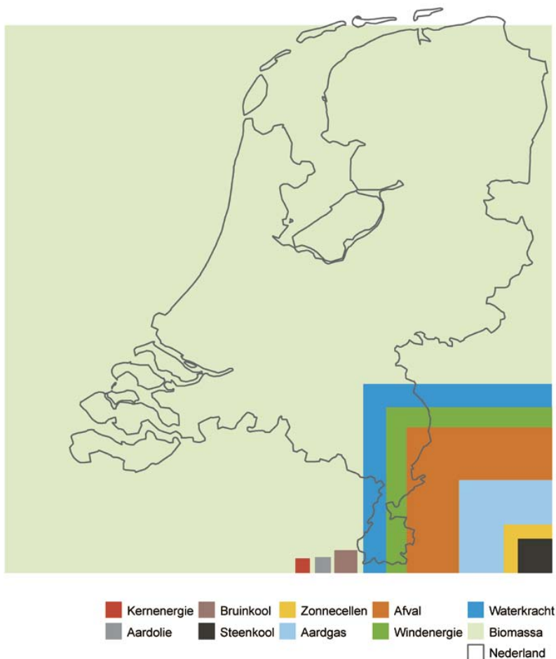
Figuur 7 Reëel ruimtebeslag van verschillende energiebronnen op basis van de huidige energievraag, indien één bron het totale elektriciteitsverbruik zou dekken 27
