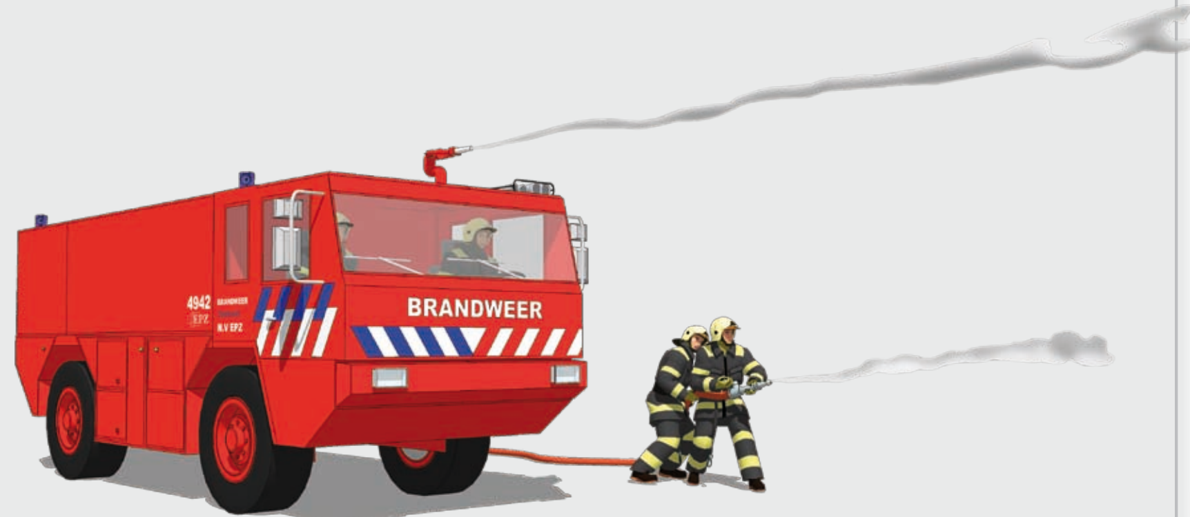
De brandweerorganisatie van EPZ beschikt over een ex-militaire crash tender . Dit schuimblusvoertuig kan worden ingezet bij transportongevallen en grote vloeistofbranden.
