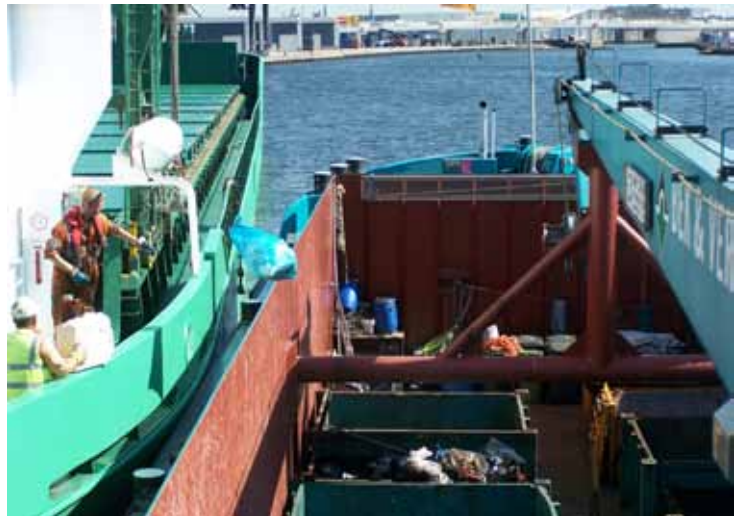
Havenontvangstinstallatie voor afval van schepen
