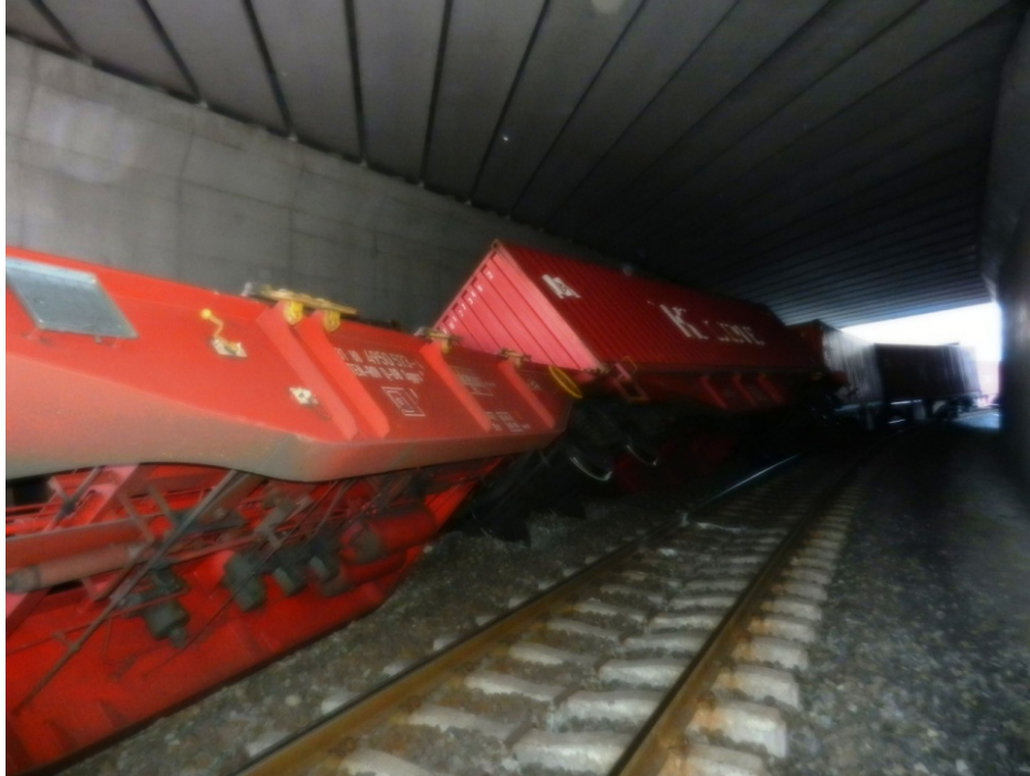
Te zien is een deel van de ontspoorde RRF-trein.
