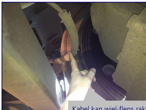
Kabel kan wiel-flens raken
