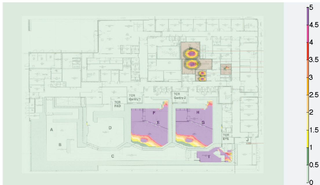
Fig. 4: Totale jaardosis in de R&D bunker. Dosis in mSv per jaar. De paarse kleur geldt voor alle waarden boven de 4.5 mSv.
