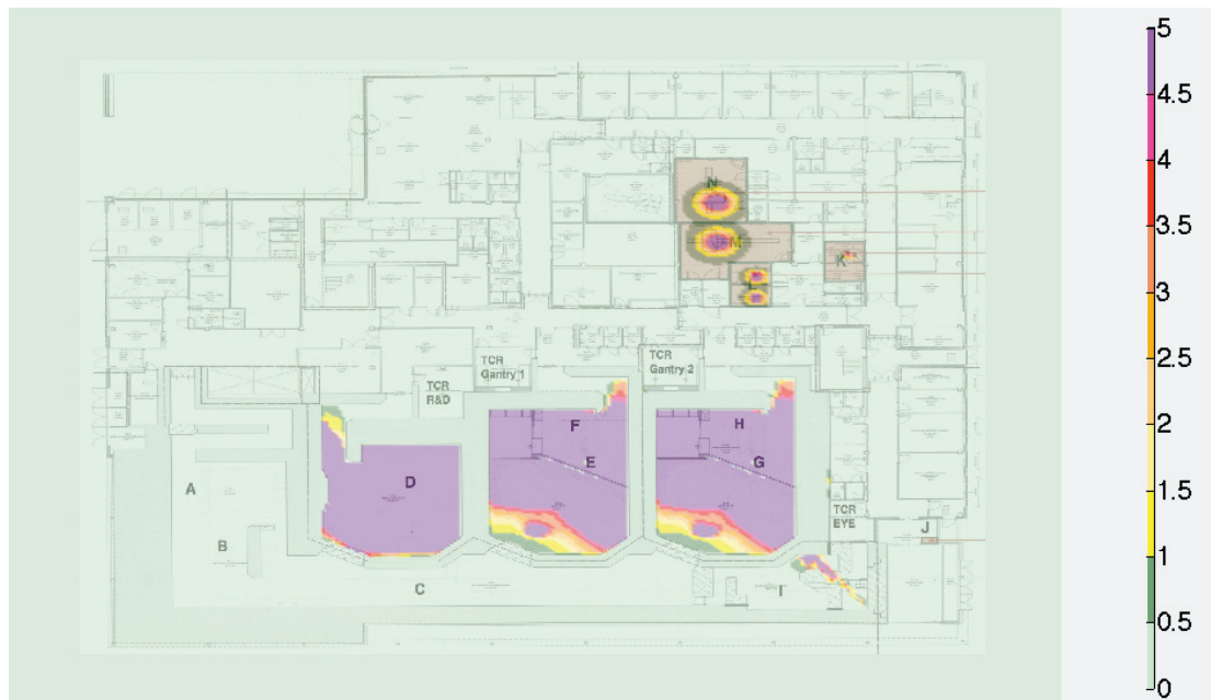
Fig. 7: Totale jaardosis in de oogbunker. Dosis in mSv per jaar. De paarse kleur geldt voor alle waarden boven de 4.5 mSv.
