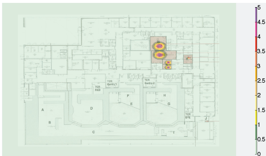
Fig. 3: Totale jaardosis als gevolg van handelingen in het imagingblok, inclusief de bijdrage van het RID. Dosis in mSv per jaar. De paarse kleur geldt voor alle waarden boven de 4.5 mSv.
