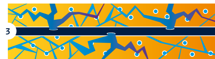
3 Onder hoge druk kraken van schalielaag met frack-vloeistof.
