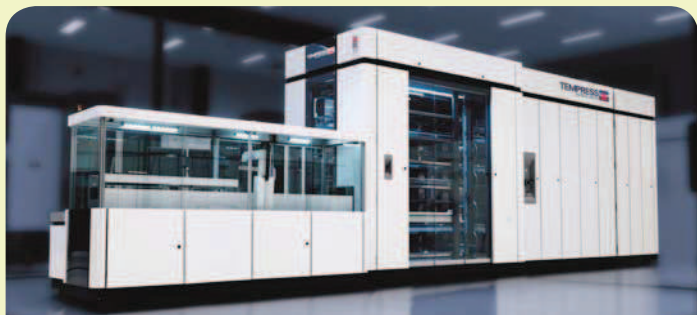
Tempress diffusie oven voor de productie van kristallijne zonnecellen ⇒ LEES MEER BRON: TEMPRESS
