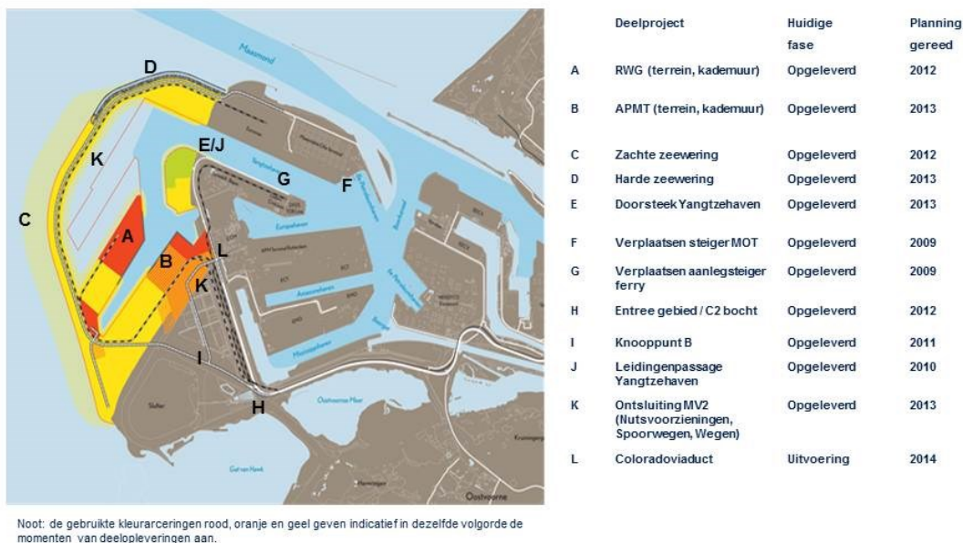
Figuur 1: Overzichtskaart belangrijkste deelprojecten Aanleg Maasvlakte 2 Eerste fase (stand juni 2014)
