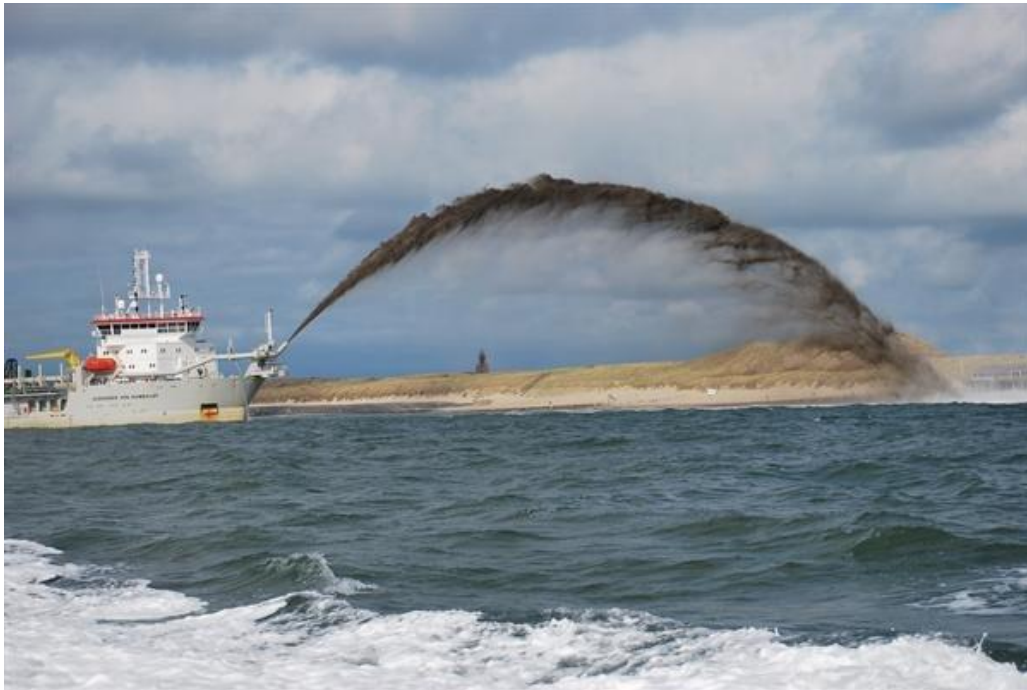
Figuur 6 – Een sleephopperzuiger is een schip dat zand, klei, slib en grind van de waterbodem kan zuigen
