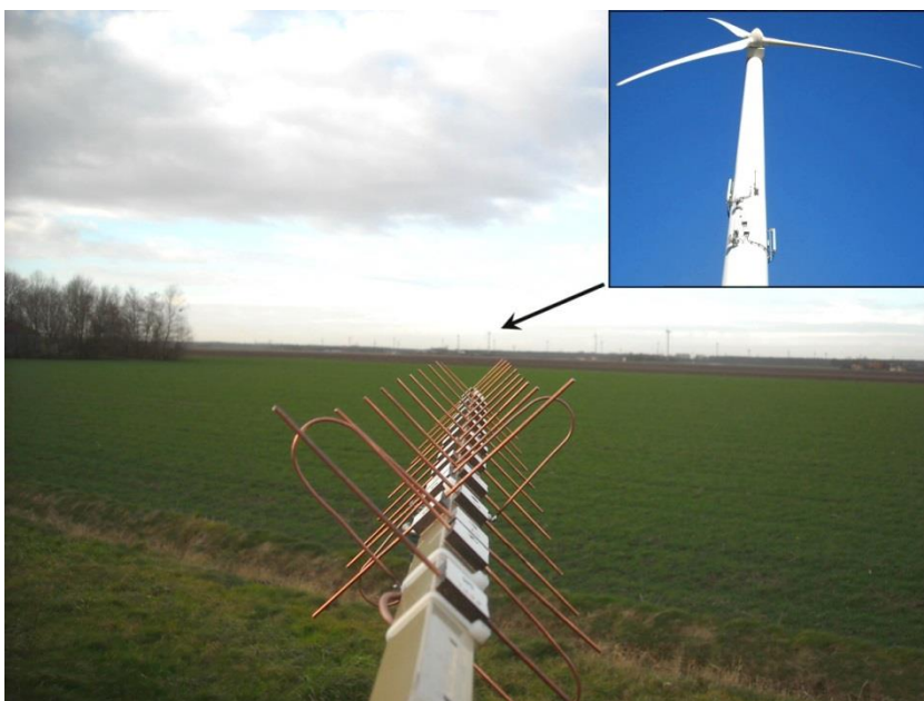
Figuur H.4: De kruisyagi (+/- parallax) gericht op een LTE-mast in een windmolen op een meetlocatie. (Foto's: R. den Besten)
