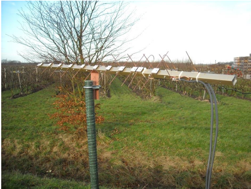
Figuur H.3: 2 x 11 element kruisyagi voor 800 MHz LTE, opgesteld bij een meetlocatie. Lengte antennekabels 2 x ca. 2m H155. (Foto: R. den Besten)
