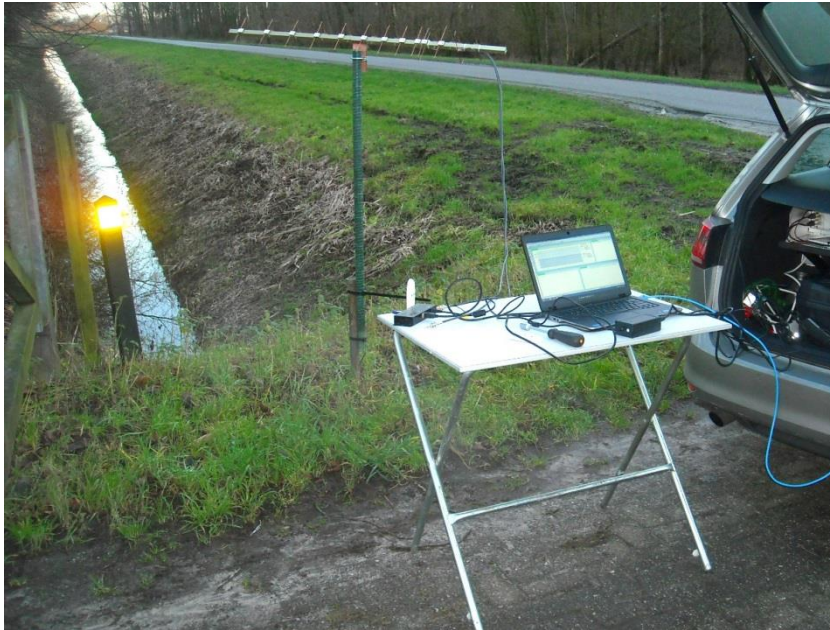
Figuur F.1: Meetopstelling richtantenne op één van de meetlocaties
