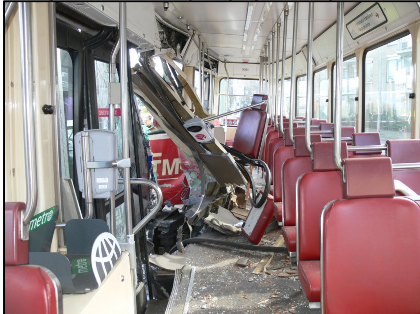
Afbeelding 12 Schade in de tram van lijn 1 als gevolg van de botsing
