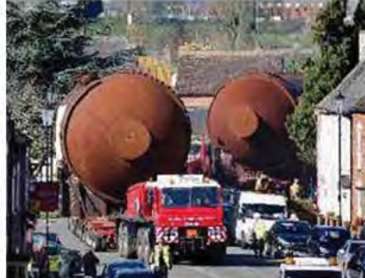
Foto 13. Berkeley-UK: Stoomgenerator op weg naar haven voor transport naar Studsvik, Nyköping, Zweden.
