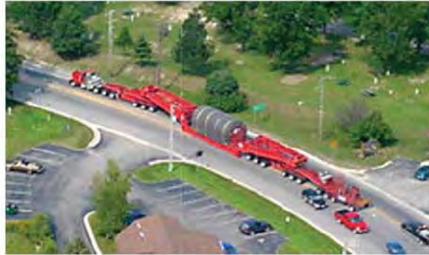
Foto 15. Big Rock Point-Michigan, USA: Transport van de verpakte reactor in transportverpakking op 205 voet lange trailer.
