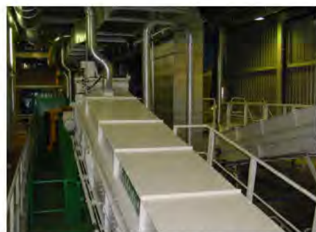
Foto 5. Eurochemie-Mol, België: kiesel-cement scheider voor beton.
