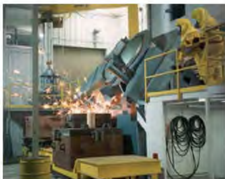
Foto 8. Energy Solutions-Tennessee, USA: Oven voor radioactief staal in Bear Creek, Oak Ridge.
