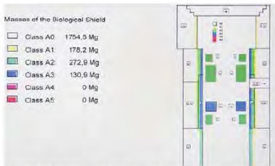
Foto 1. GKN-Dodewaard, NL: Als radioactief afval te verwerken deel van het biologisch schild.
