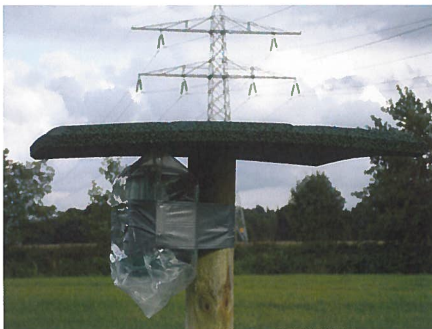
Figuur 5 De magneetveldmeter in plastic doos op 1 m hoogte
