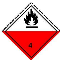
(Nr.4.2) Symbool (vlam): zwart; Achtergrond: bovenste helft wit, onderste helft rood; cijfer "4" in de benedenhoek
