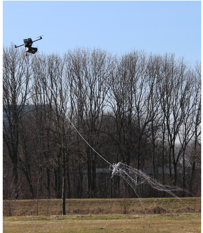
Bewerkte foto uit fase 1 waarbij het veilig afvoeren van de gevangen drone aan een kabel wordt getoond.
