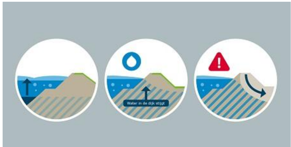
Fig. 0.1: Verlies van stabiliteit in het binnentalud (bron: www.markermeerdijken.nl )
