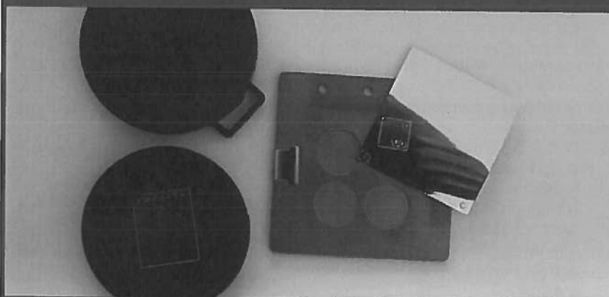
Figuur 9 Gedemonteerde radon- (links) en thorondochterdetector (rechts).
