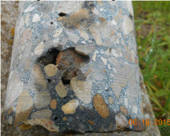
Afbeelding 1.3. Luchtinsluitingen kern X8-onder
