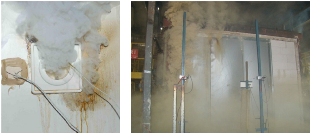
Afbeelding 1.1: rookdoorlatendheid van een brandwerende scheidingsconstructie (bron: Efectis)
