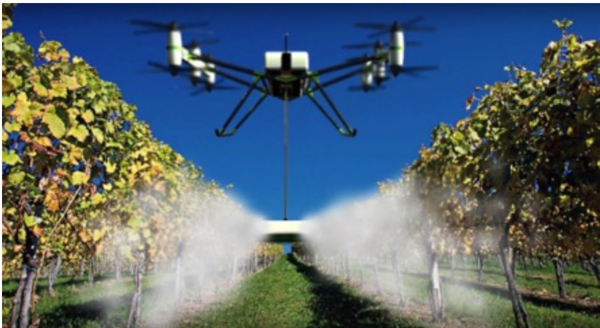
Figuur 17 'Het vliegende werkpaard' van Drone4Agro. Een onbemand platform dat 100 kg aan payload kan tillen (bron: YouTube / Drone4Agro).
