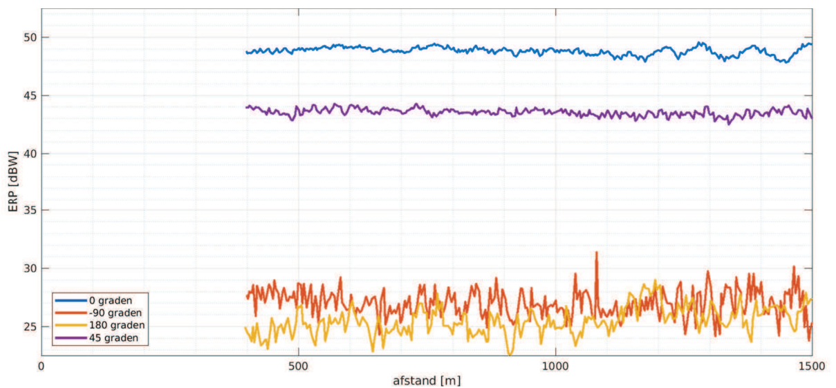
Figuur 5.4.2: Ontvangen uitgestraalde vermogen (e.r.p.) versus de afstand voor het directionele antennediagram voor verschillende aanvlieghoeken
