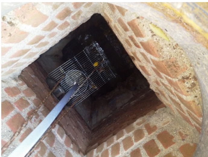
Figuur 8.1-4. Gebruikte constructie voor de monstername bij het verpleeghuis.
