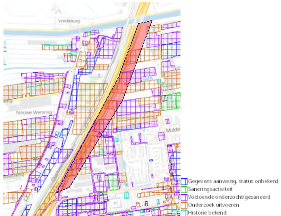
Figuur 9.6: Bodemverontreinigingen bij het nieuw aan te leggen Ringvaart-aquaduct in de alternatieven A-O en B-O. Het zoekgebied voor de nieuwe wegligging is met rood weergegeven.
