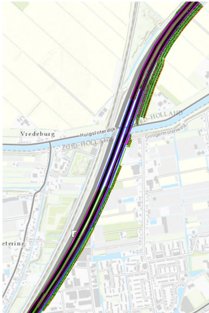
Figuur 9.1: Nieuw ruimtebeslag van de A4 bij het realiseren van het aquaduct Oost.
