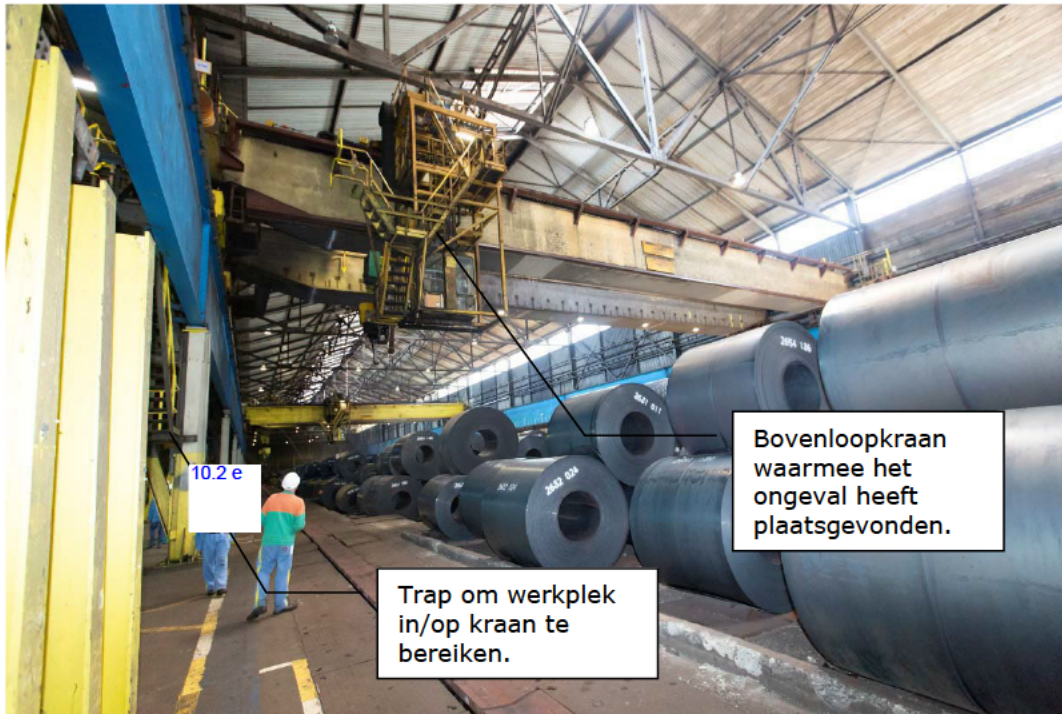
Foto 5: Zicht op andere zijde bovenloopkraan.
