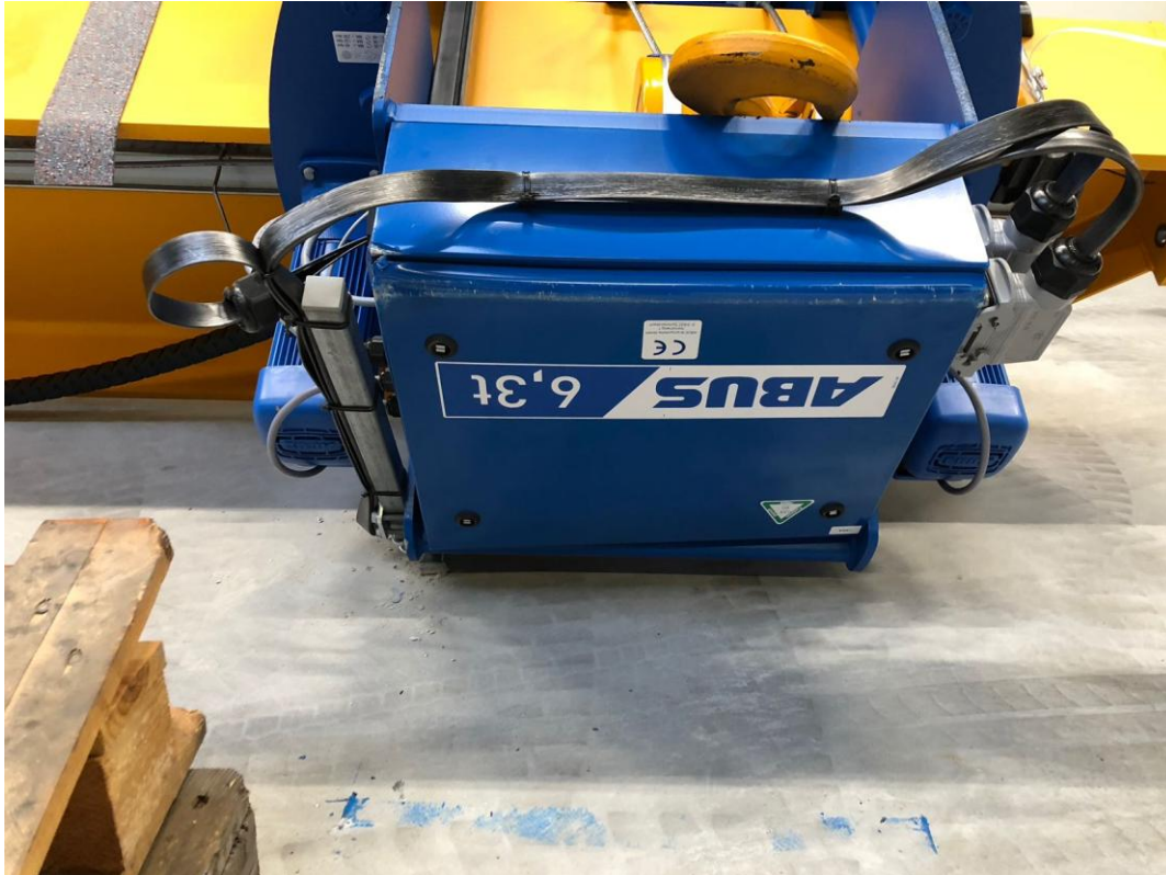
Foto 3: Links van de loopkat zag ik op de vloer van de werkplaats blauwe verfsporen. Aan de linkerzijde van de loopkat zag ik beschadigingen in de blauwe verflaag van de loopkat. Ik zag dat de blauwe verfsporen op de grond overeenkwamen met de beschadigingen in verflaag van de blauwe loopkat. Ook zag ik dat de kleur van de verfsporen op de grond dezelfde was als de kleur van de loopkat.
