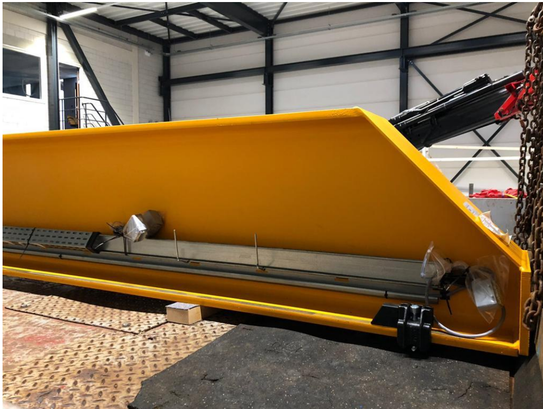
Foto 9: Foto ontvangen van de heer 10.2.e . Ik zag op de foto dat de kraanbalk op de vrachtwagen was geladen op smalle houten balkjes. Ik zag dat de kraanbalk niet was geladen op dikke houten balken of bokken.
