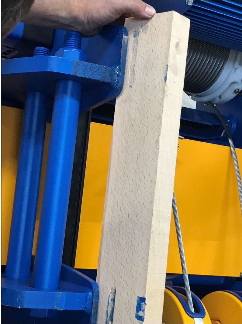
Foto 4: Op het houten balkje zag ik blauwe verfsporen en een afdruk. Ik zag dat de kleur van de verf dezelfde was als de kleur van de loopkat. Ik zag dat de afdruk in het houten balkje afkomstig was van de blauwe loopkat.
