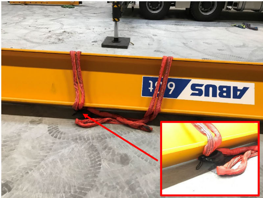
Foto 5: In het midden van de kraanbalk zag ik een oranje rondstrop om de kraanbalk. Onder de kraanbalk zag ik een veiligheidsschoen bekneld tussen de kraanbalk en vloer van de werkplaats.
