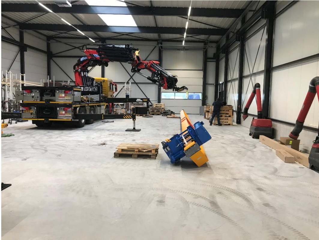
Foto 1: Ik zag op de vloer van de werkplaats een gele kraanbalk met aan de voorzijde een blauwe loopkat. Ik zag dat de kraanbalk ondersteboven op de vloer lag.
