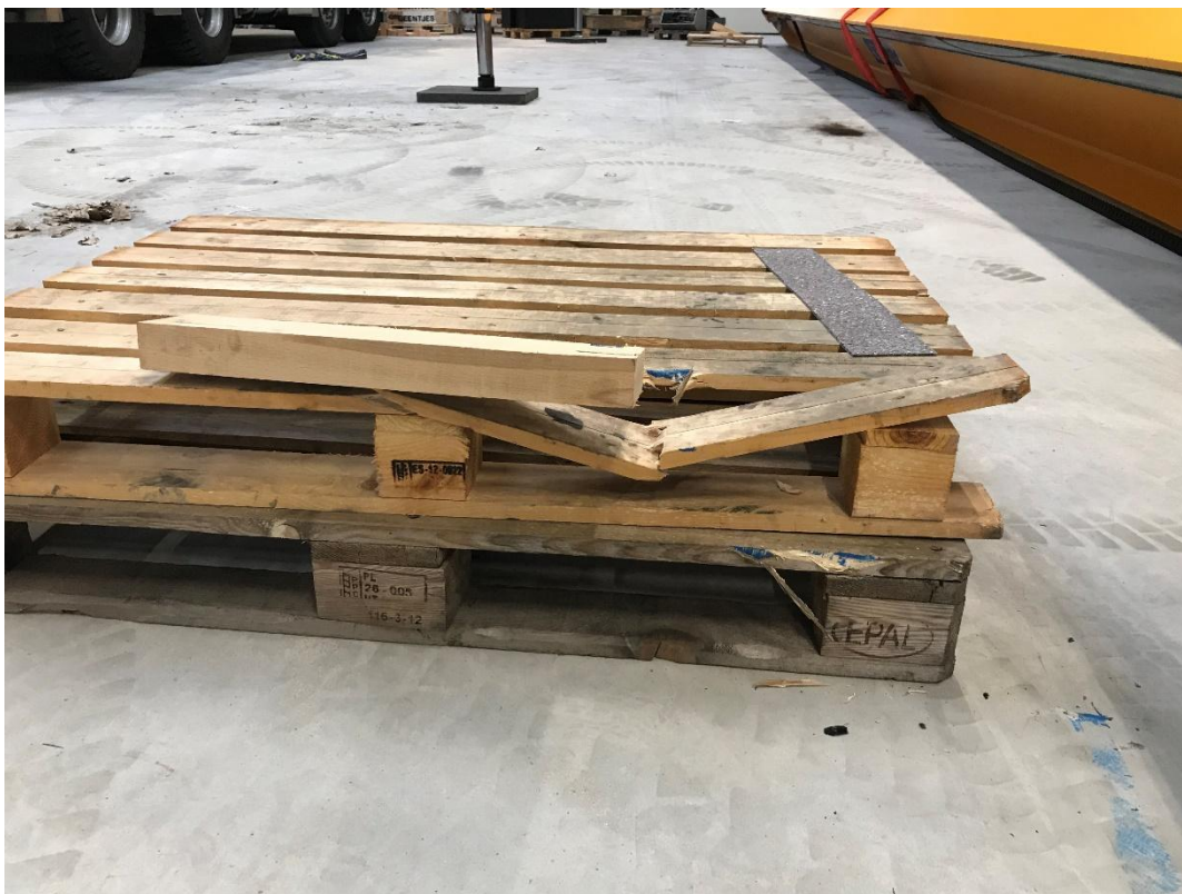
Foto 2: Links van de loopkat zag ik op de vloer een stapel van twee houten pallets met daarop een houten balkje. Ik zag dat het houten balkje in het midden van de voorste plank van de bovenste pallet lag. Ik zag dat de voorste plank van de bovenste pallet gebroken was. Op de planken van de twee pallets zag ik blauwe verfsporen.
