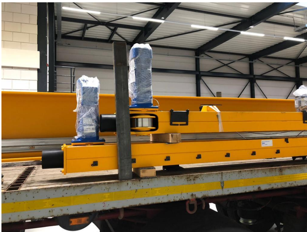
Foto 10: Foto ontvangen van de heer 10.2.e . Ik zag op de foto dat de kraanbalk op de vrachtwagen was geladen op smalle houten balkjes. Ik zag dat de kraanbalk niet was geladen op dikke houten balken of bokken.
