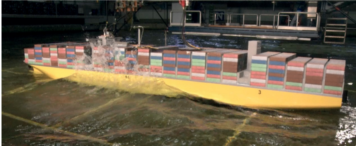
Figuur 26: Beelden van het scheepsmodel op het moment van het optreden van het groenwater fenomeen. (Bron: MARIN)
