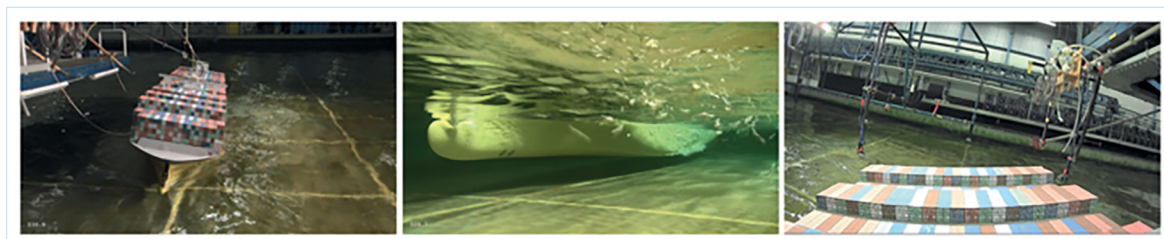
Figuur 15: Foto's van het scheepsmodel in het MARIN testbassin, respectievelijk met beelden bovenwater, onderwater en vanaf de brug van het schip.
