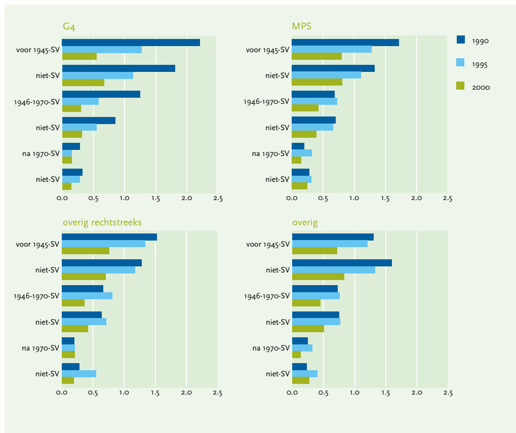
Figuur 2.5 Ontwikkeling van de relatieve herstelkosten per woning in bestaand stedelijk gebied, onderverdeling naar bouwperiode per WSDV-gemeente (index: 1990=1) (Bron: KWR)
