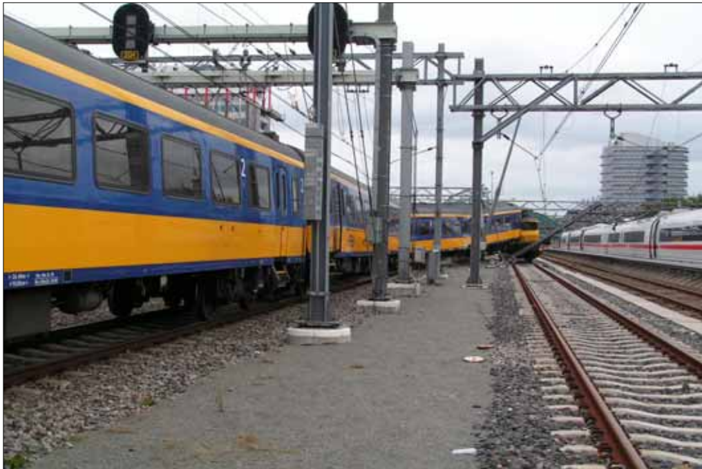
Afbeelding 12: De locomotief komt op spoor 26 tot stilstand. Het laatste (12 e ) rijtuig staat tussen spoor 26 en spoor 31.
