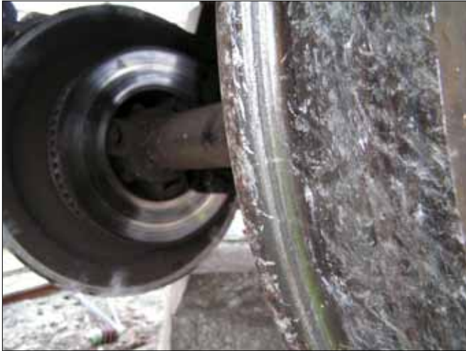
Afbeelding 16: Loopvlak rechter wiel van het achterste wielstel 840503 van achterop lopende draaistel RA 643 van het 12e en laatste rijtuig.
