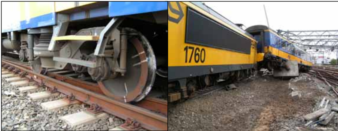
Afbeelding 13: Sporen van contact met betonnen dwarsliggers op het loopvlak van het wiel van het één na laatste (11 e ) rijtuig.
