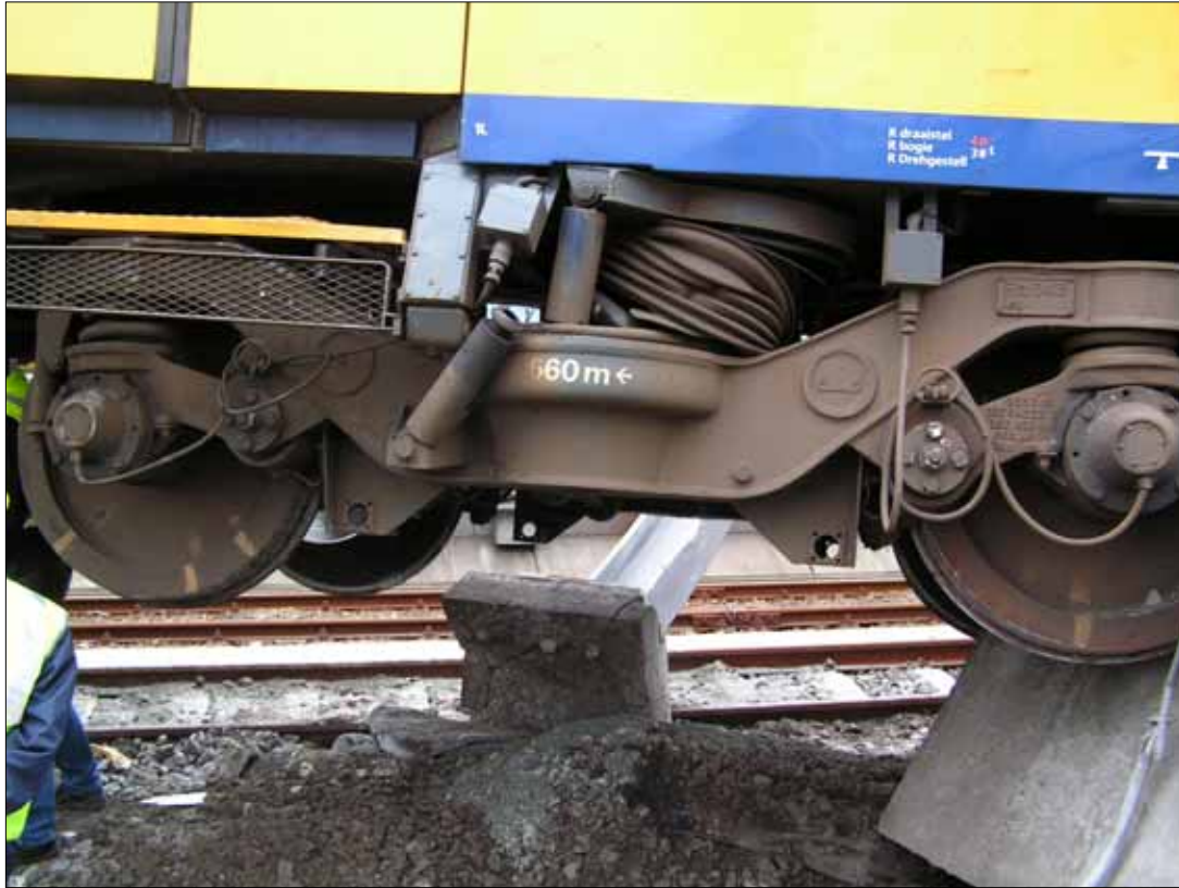
Afbeelding 15: Het achterste draaistel van het laatste rijtuig tegen de betonvoet.
