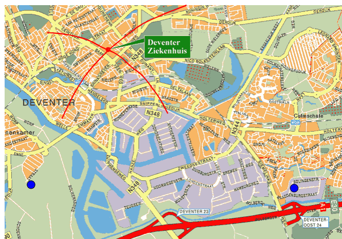
Figuur 5b: Principe kruispeiling bij een co-operatieve peil zender (voorbeeld is geheel gefingerd)
