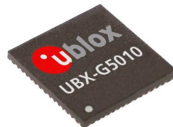
Figuur 3.2b: GPS ontvangerchip, state-of-the art), 8x8 mm oppervlak, excl. antenne
