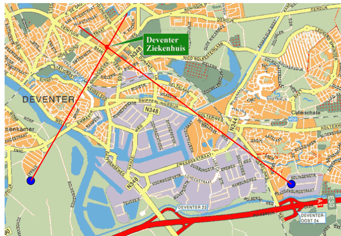
Figuur 4a: Principe kruispeiling bij een non-cooperatieve zender (voorbeeld is geheel gefingerd)
