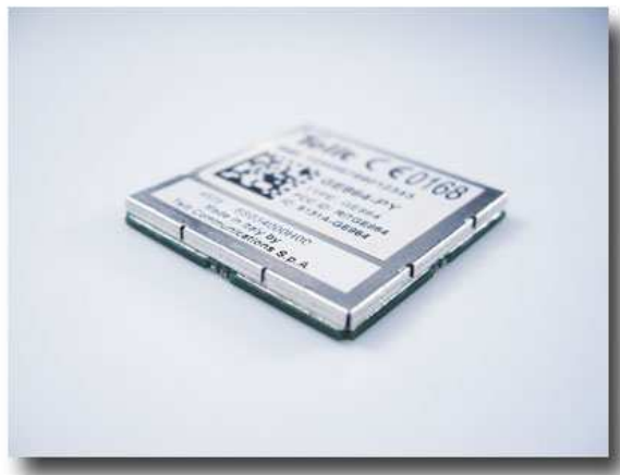
Figuur 3.2.1 Geïntegreerde GSM/GPRS-module, (30x30mm) exclusief antenne
