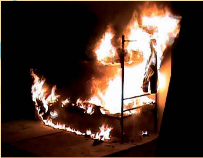
Reconstructie (brandproef) brand in cellencomplex Schiphol-Oost. Afbeelding uit film Onderzoeksraad voor Veiligheid bij presentatie rapport.
