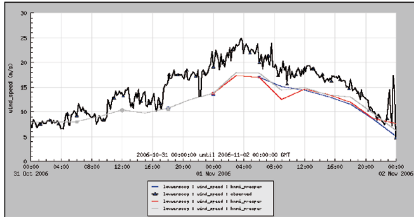
..... Figuur 2.10: Gemeten windsnelheid [m/s] bij Lauwersoog (zwart), en verwachte windsnelheid uit het HiRLAM model met de volgende starttijden: 2006-10-31 18:00:00 (grijs); 2006-11-01 00:00:00 (rood); 2006-11-01 06:00:00 (blauw).
