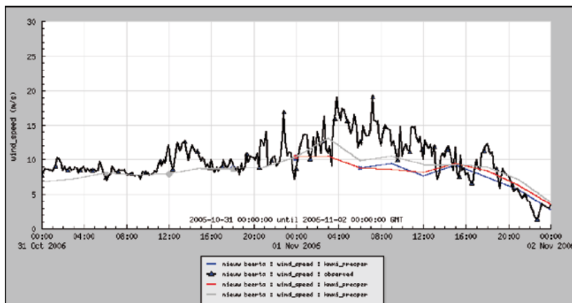
Figuur 2.12 Gemeten windsnelheid [m/s] bij Nieuw Beerta (zwart), en verwachte windsnelheid uit het HiRLAM model met de volgende starttijden: 2006-10-31 18:00:00 (grijs); 2006-11-01 00:00:00 (rood); 2006-11-01 06:00:00 (blauw).
