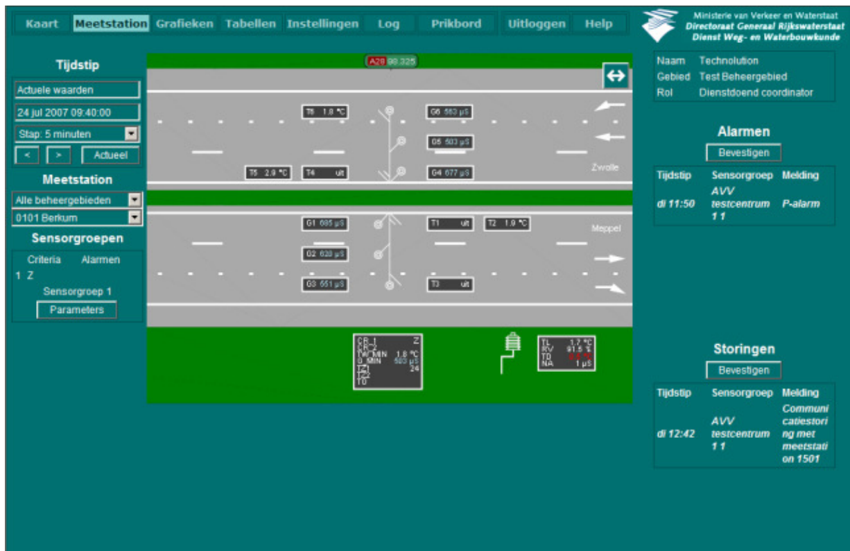
Overzicht kanalen van een meetstation
