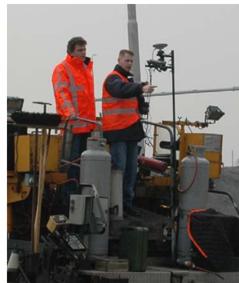
figuur 4 – gemonteerde infrarood camera en GPS ontvanger op spreidmachine
