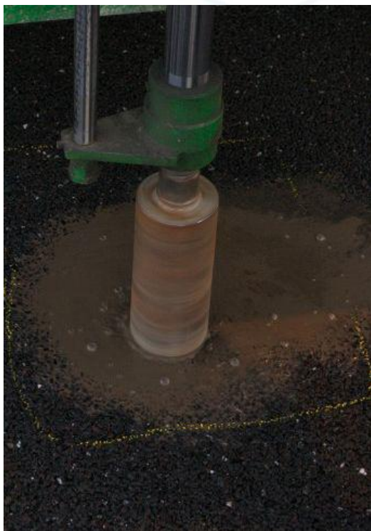
Figuur 20 Nemen van een boorkern in het proefvak
