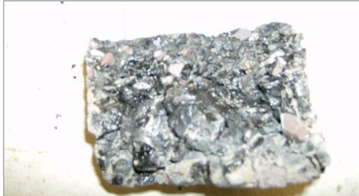
Figuur 21 Foto één van de gespleten boorkernen.
