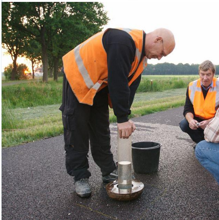
Figuur 19 Proef met toestel van Becker
