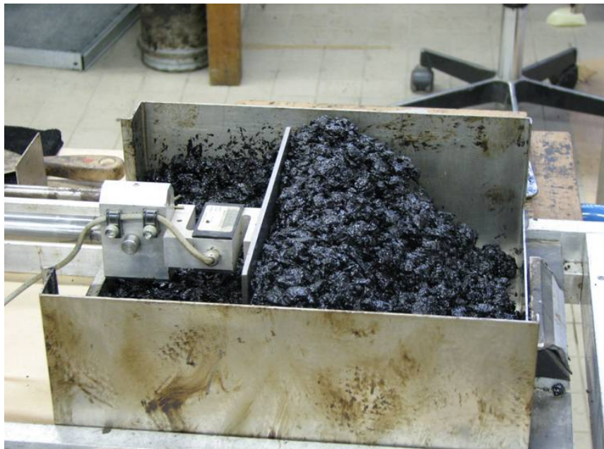
Figuur 6: principe afschuiven specie
